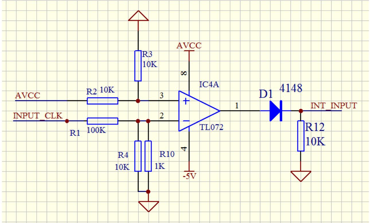
INPUT\_CLK 为刺激输入端，其电平范围为直流电压 100-500V 之内，脉冲宽度 > 10 $\mu$ s。
