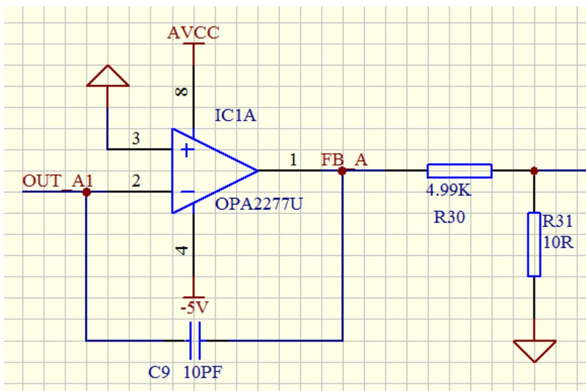
DA 芯片输出信号 OUT\_A1 经过电阻分压后形成所需信号，幅度及频率变化范围有 DA 芯片进行转换输出。
