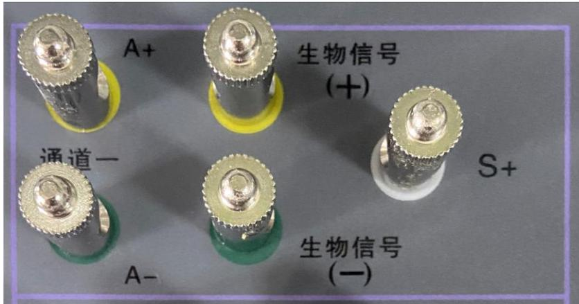
在软件通道一的窗口设置中，设置波形的类型，频率及幅度后，模拟仪将通过通道一的输出端子输出信号，幅度对应如下：
