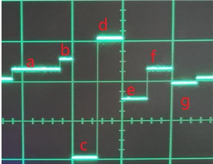
波形 a 幅度=设置波形幅度/16 波形宽度=设置波形周期/4
